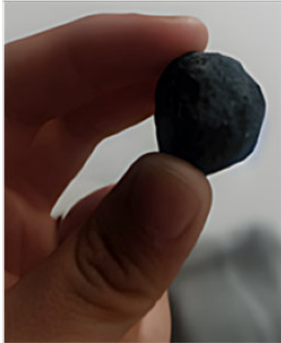
Nódulo de clinker antes de ingresar al molino de bolas para cemento. (Ilustración propia)
