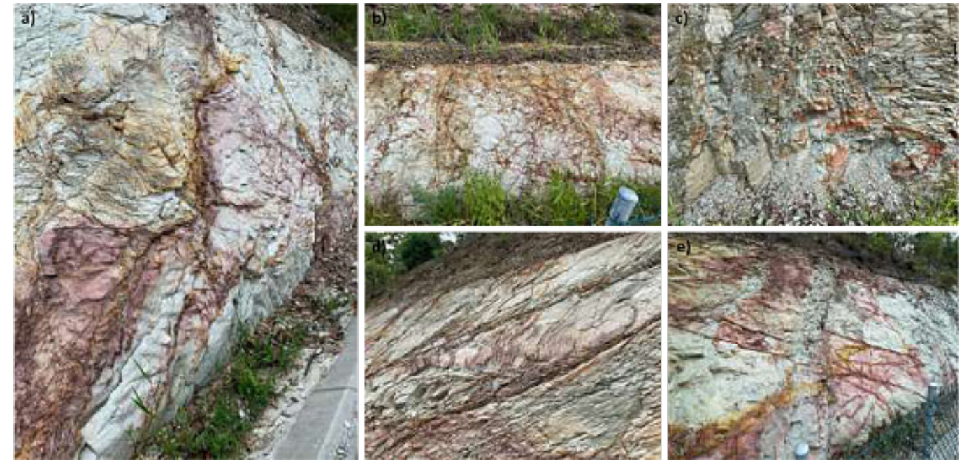
Figura 9. Diversas vistas de rocas multicolores del GNF a lo largo del corte de la Old Cleveland Road. Además de las variadas tonalidades de colores, se distingue el carácter arcilloso de la secuencia, la fina laminación, el clivaje pizarroso y la intensidad de fracturamiento. Se observan fracturas, venas y venillas en todas direcciones, mineralizadas o no, e incluso pequeñas fallas. (Fotos J. Porras)
