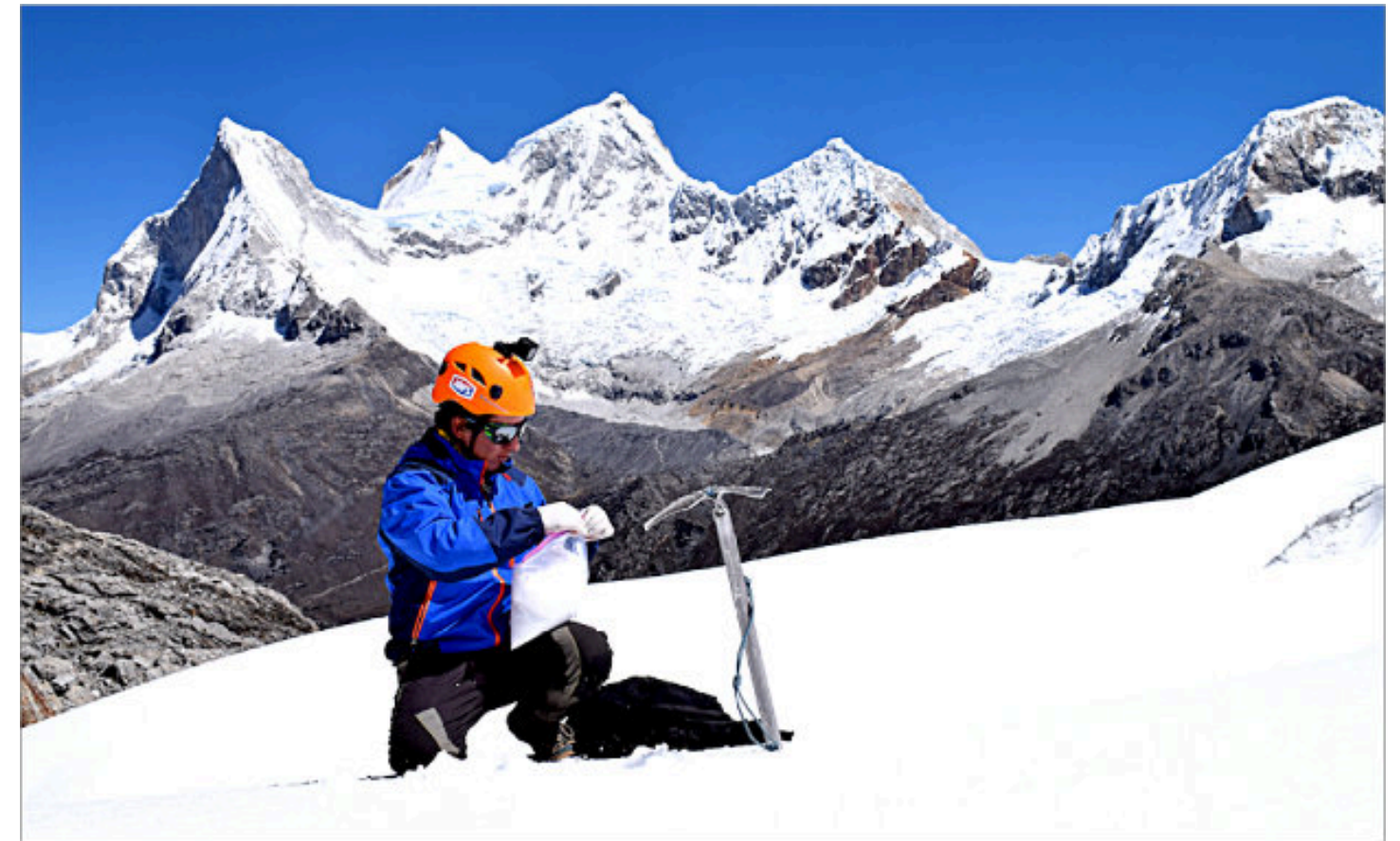
Figura 4. Muestreo de nieve superficial para determinar la concentración de carbono negro. Fotografía: Wilmer Sánchez.
