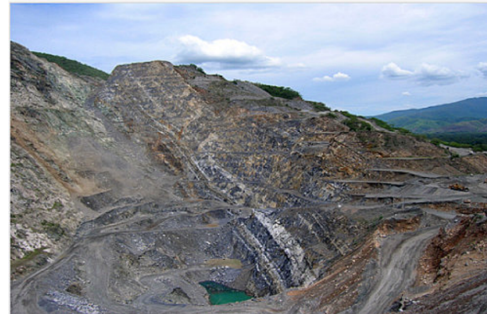
Figura 11. Vista de los estratos de caliza reemplazados por mineral de hierro en el yacimiento de Cerro Náhuatl.
