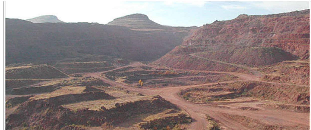
Figura 5. Yacimiento La Perla, Chihuahua. La forma original del yacimiento fue la de una lente de 1,200 m de longitud por 700 m de anchura y aproximadamente 75 m de profundidad.
