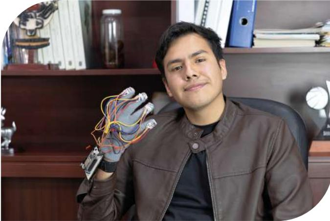
Con cada movimiento, los sensores generan datos, es decir una letra, que se envía en tiempo real a una tarjeta de control colocada en el antebrazo del usuario, la cual recibe la información y la transmite vía *Bluetooth* al otro dispositivo. Al final, el destinatario puede deletrear el mensaje que se origina en el guante.
